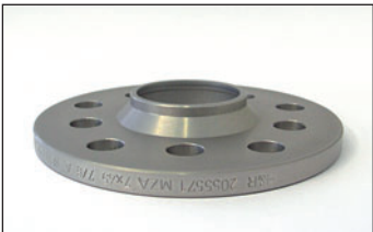
Artikel-Nr./Part-no. 2055571A: Radnabenlänge max. 15,5 mm. Felgeninnenfase mind. 6,5x45° Wheel hub length max. 15,5 mm. Inner bavel 6,5x45°.
