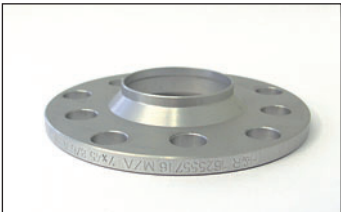
Artikel-Nr./Part-no. 162555716: Radnabenlänge max. 14 mm. Felgeninnenfase mind. 7x45° Wheel hub length max. 14 mm. Inner bavel 7x45°.
