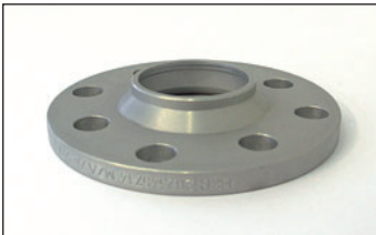
Artikel-Nr./Part-no. 202345714: Radnabenlänge max. 16 mm. Felgeninnenfase mind. 7x45° Wheel hub length max. 16 mm. Inner bavel 7x45°.
