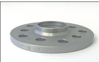
Artikel-Nr./Part-no. 2055571B: Radnabenlänge max. 12 mm. Felgeninnenfase mind. 4x45° Wheel hub length max. 12 mm. Inner bavel 4x45°.
